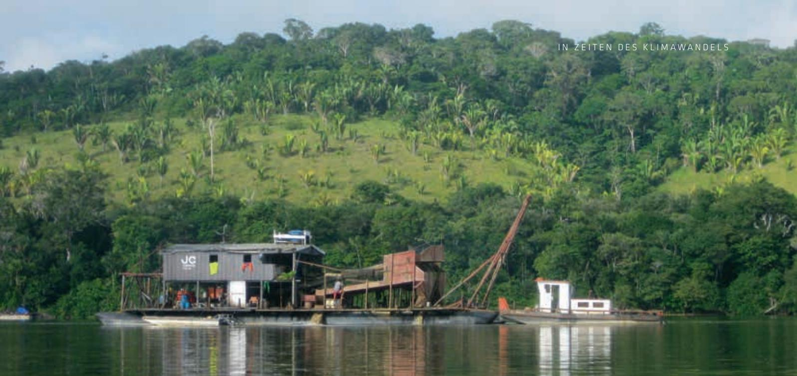
Goldwäscher am Rio Tapajós: Das Fluss-Sediment wird abgesaugt und anschließend zurückgepumpt. Dabei gelangt immer wieder Quecksilber in den Fluss.
